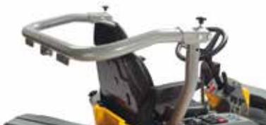
Überrollschutz (ROPS) kann nach hinten geklappt werden, um das Fahren unter Bäumen zu ermöglichen. Ein Sicherheitsgurt ist inbegriffen.
