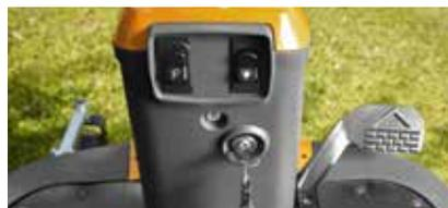
Zündschlüssel, Licht und die Elektromagnetkupplung sind einfach erreichbar.
