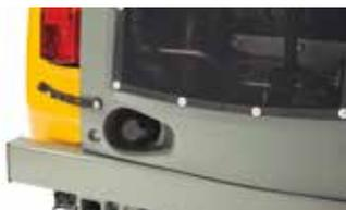
Einfacher Zugang zu elektrischen Anschlüssen für Anhängerbeleuchtung und elektrisch betriebener Anbaugeräte.
