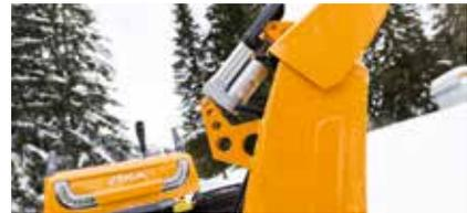
Einer von zwei leistungsstarken, elektrischen Stellmotoren, die für die zielgenaue Wurfweite und -richtung sorgen.
