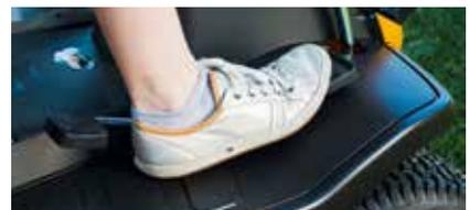
Komfort auch bei dem kleinen Aufsitzmäher. Beim Hydrostatgetriebe regelt man den Fahrantrieb über eine Pedalwippe.
