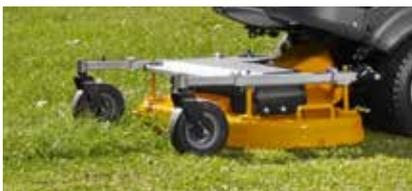
Zwei synchronisierte Messer und ein optimierter Luftsog sorgen für ein optimales Schnitt- und Fangergebnis.
