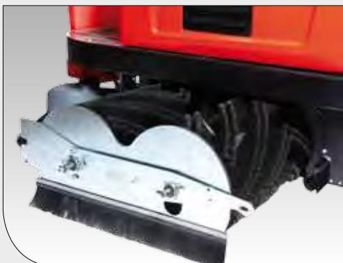
Werkzeugloser Bürstenwechsel in weniger als 3 Minuten.
